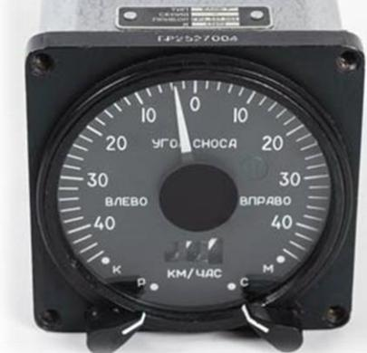
Принцип работы ДИСС основан, как следует из расшифровки, на использовании эффекта Доплера, согласно которому «Частота принятого сигнала, отражённого от цели, может отличаться от частоты излучённого сигнала, и разница зависит от скорости объектов относительно друг друга.»
